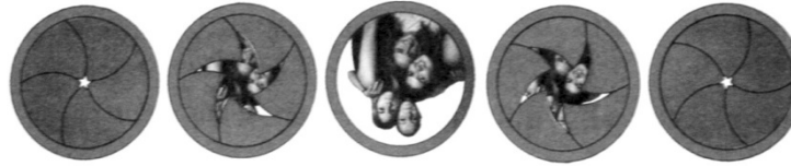
Esquema de funcionamiento del Obturador Central
